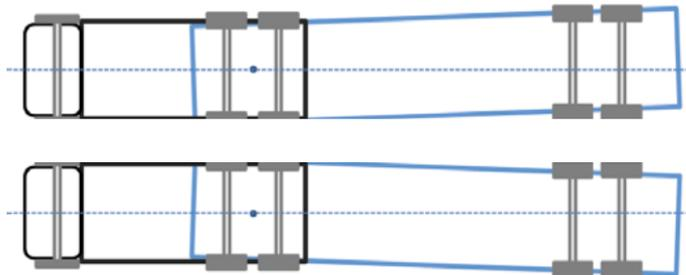
Una alineación mal realizada puede provocar desgaste irregular de llantas.
